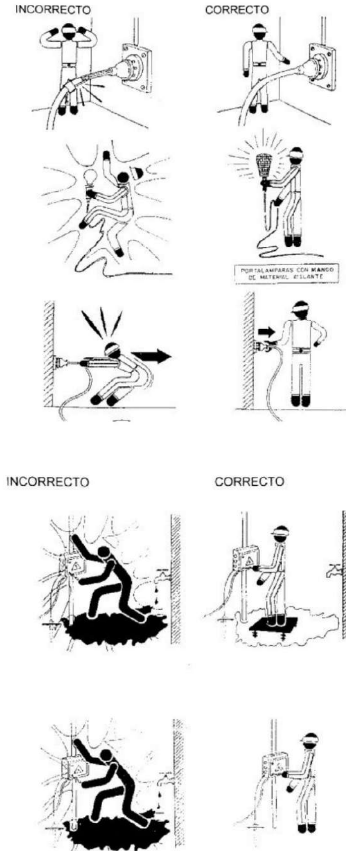
Figura.22. Señales riesgo eléctrico.
