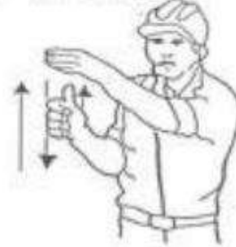
4 Levantar el aguilón o pluma lentamente
