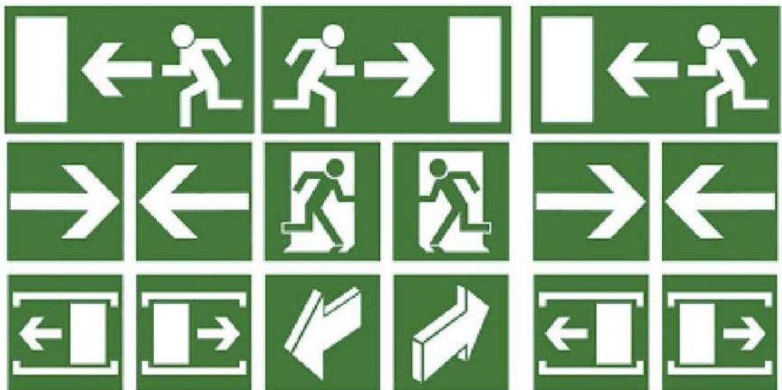
Figura.14. Señales de información de seguridad.
