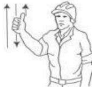
4 Levantar el aguilón o pluma lentamente
