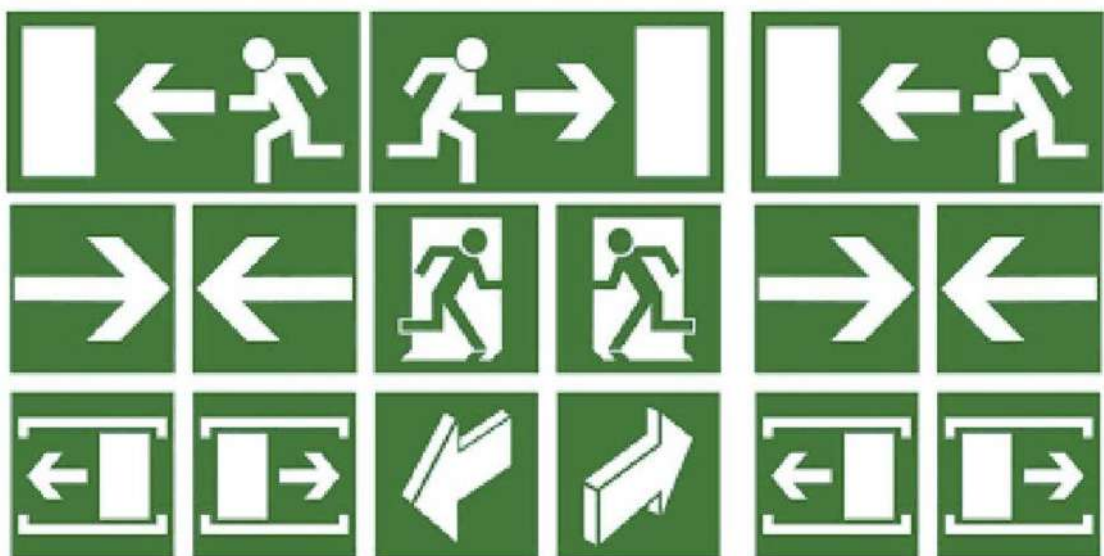
Figura.14. Señales de información de seguridad.
